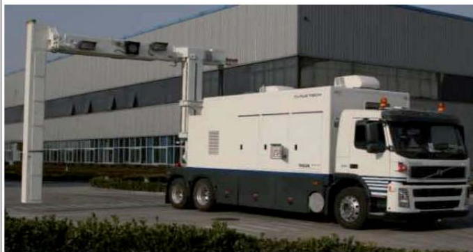
Fig.2 L'état de balayage du Système Mobile MT1213DE par NUCTCH™
